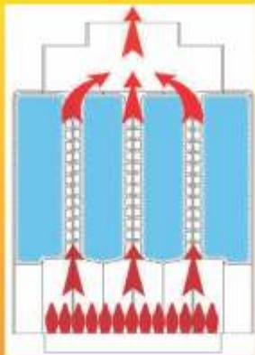
Grâce au trajet de l'échangeur de 7,3 pi (22m) de chaleur du B10 comparé à 1,5 pi (46cm) des chaudières type à tige, notre chaudière à trois passages chauffe davantage la surface par gallon de matériaux de chauffage brûlés et échappe 50% moins de chaleur par la cheminée.
