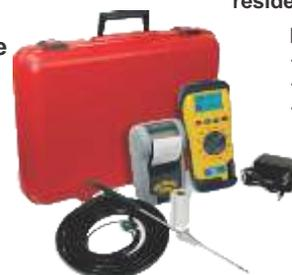
L'analyseur C75 est le modèle de base et offre une alternative de coût pour les applications de combustion résidentielles.
